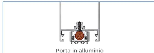
• **CARATTERISTICHE** Meccanismo con una singola regolazione (vite F: discesa) caratterizzato dal movimento controllato del profilo mobile con guarnizione (discesa immediata dal lato cerniere della porta e conseguente discesa graduale per tutta la lunghezza) per un adeguamento al pavimento.
